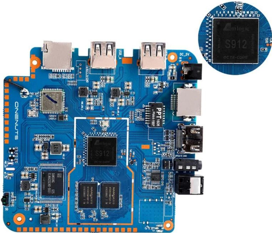
ONENUTS S912 是一款基於 Amlogic S912 八核處理器的迷你電腦主機板。它支援 8GB RAM、32GB 儲存空間，並提供多種連接埠，包括 USB-A、USB-C 和 micro-USB。該主機板設計緊湊，適合用於各種嵌入式應用。
