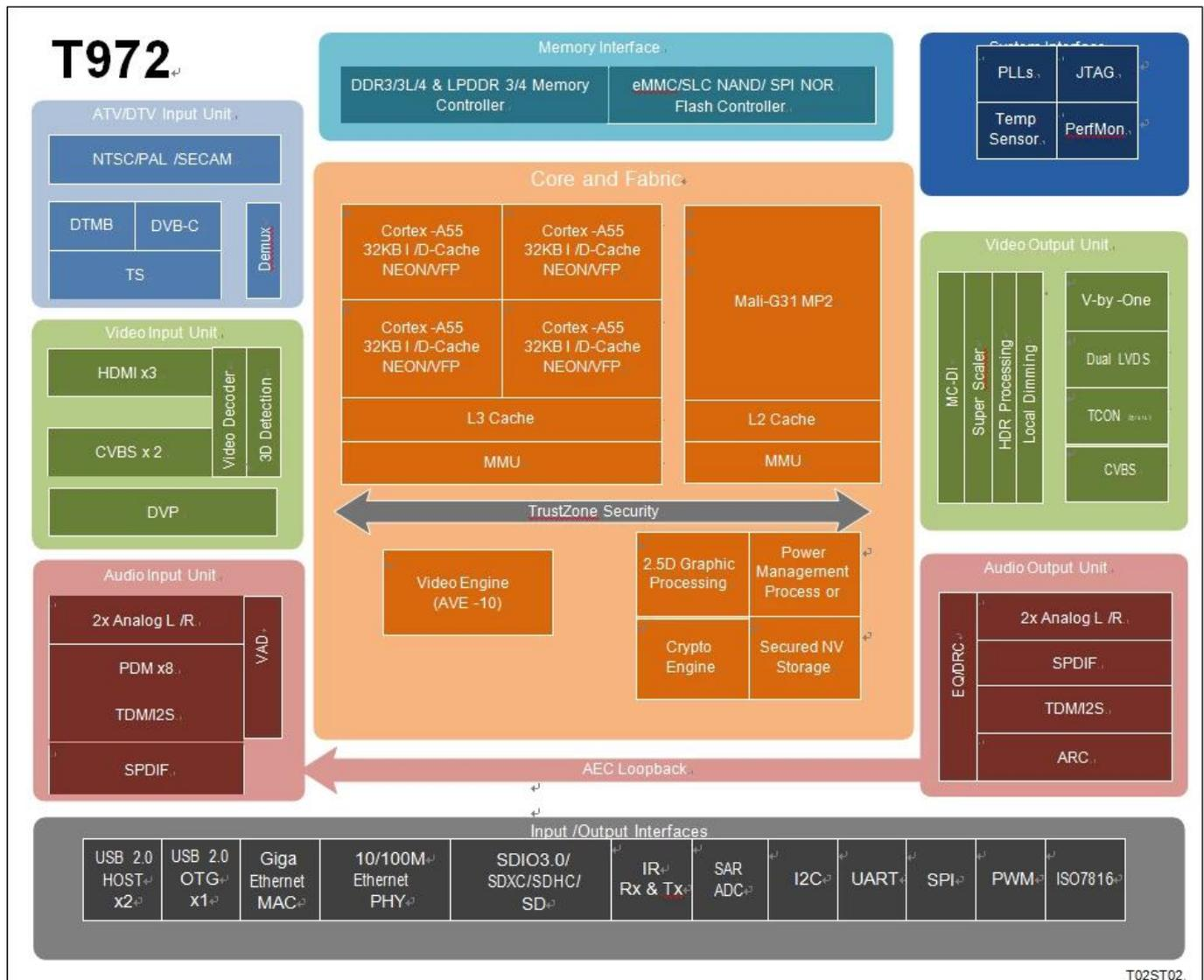
**Amlogic T972** è un processore applicativo avanzato progettato per applicazioni TV UHD in tutto il mondo. Integra un potente sottosistema CPU/GPU, una pipeline di elaborazione delle immagini HDR migliore della categoria, un motore CODEC video 8K/4K protetto con tutte le principali periferiche per formare il chip TV intelligente più conveniente.
