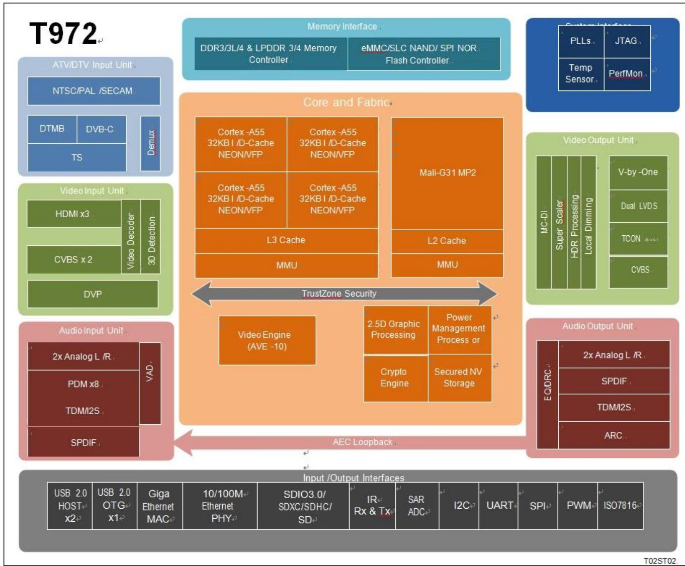
**Amlogic T972** — это усовершенствованный процессор приложений, предназначенный для приложений UHD TV по всему миру. Он объединяет мощную подсистему CPU/GPU, лучший в своем классе конвейер обработки изображений HDR, защищенный механизм видеокодека 8K/4K со всеми основными периферийными устройствами, образуя непревзойденный экономичный чип Smart TV.
